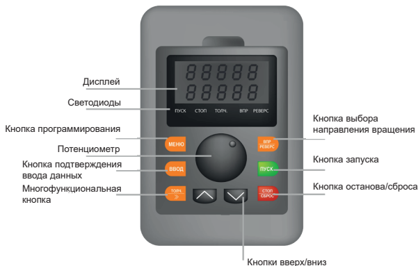
Рис. 5.1 Функции кнопок и светодиодов панели управления LCI
