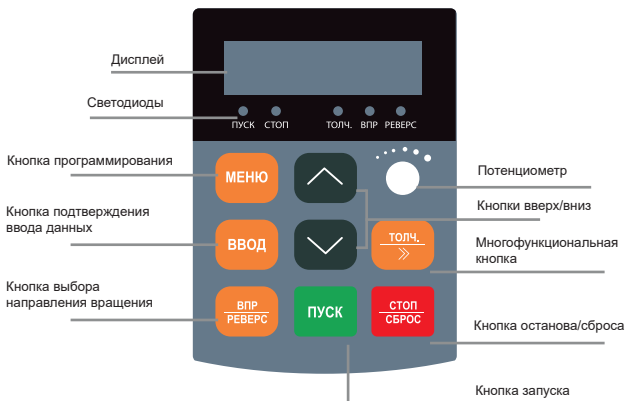
Рис. 5.2 Функции кнопок и светодиодов панели управления LCI(S)
